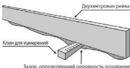
Рис. 1. Измерение неровности основания.
